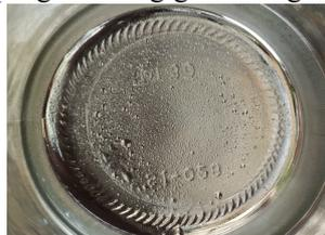
Gambar 11. Gelembung pada Dasar Tabung Bagian Dalam
